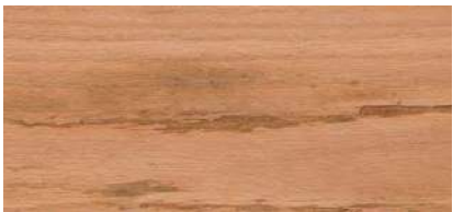
ROULURE Fente tangentielle qui suit la direction des cernes de croissance annuelles.
