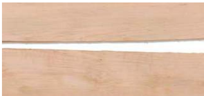
FISSURE Séparation longitudinale du bois qui se produit lorsque le bois est séché.
